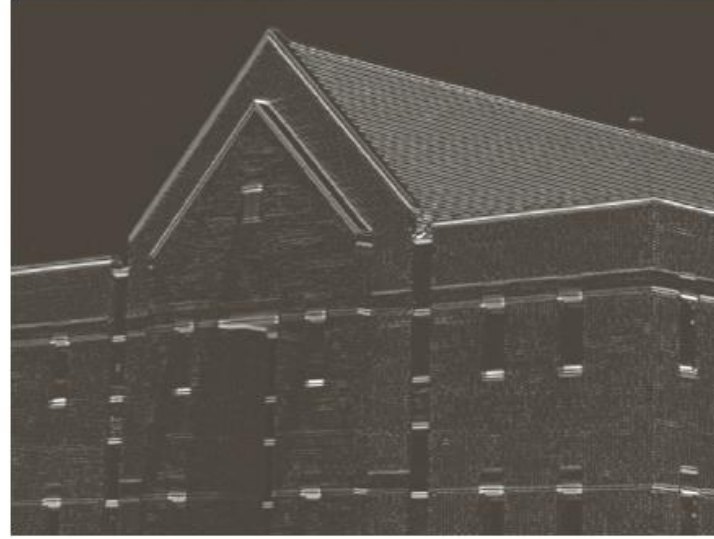
ŞEKİL 10.18 Ayrıt saptama amacıyla 5 \times 5 bir ortanca süzgeç kullanarak yumuşatılmış ori- jinal görüntü ile oluşturulan Şekil 10.16'daki aynı görüntü dizisi.
